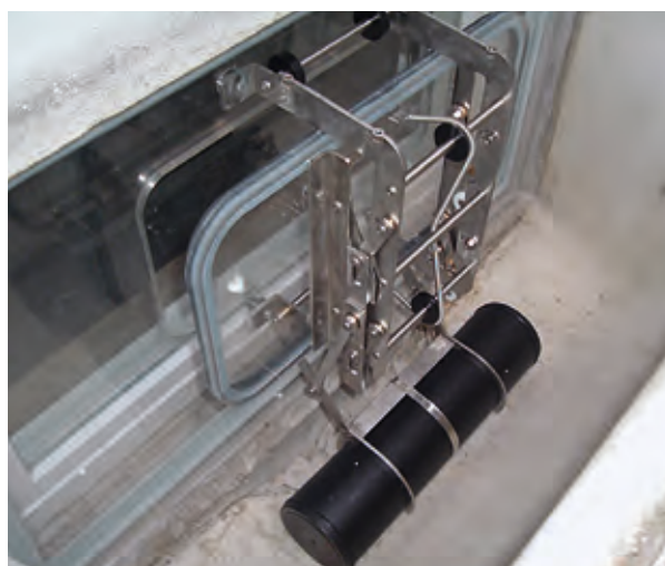
Automatisch schließende Vorsatzscheibe
